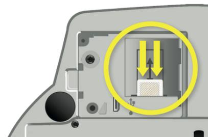
**4.** Im SIM-Karten-Schlacht befindet sich schon eine SIM-Karte leicht eingesteckt. Diese schieben Sie in Richtung der gelben Pfeile bis zum Anschlag hinein (siehe Abb. links, gelber Kreis). Jetzt ist das Gerät betriebsbereit und in wenigen Augenblicken aktiv. Es dauert nur ca. 1 Minute, bis der Empfang zu unserer Notrufzentrale hergestellt ist. Das löst natürlich noch keinen Notruf aus!
